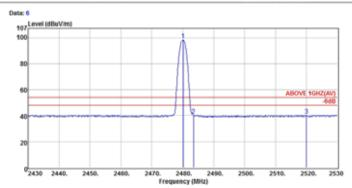
: Audix NO.1 Chamber : 3m 3115(4927) : ABOVE 1GHZ(AV) : 28\*C / 43% N9010A : TB71A : DC5V Site no. Dis. / Ant. Limit
