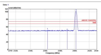
: Audix NO.1 Chamber : 3m 3115(4927) : ABOVE 1GHZ(PK) : 20\*C / 43% N9010A : TB71A-H : DC5V : Out of band SDPSK Site no. Dis. / Ant. Limit Env. / Ins. EUT
