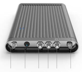
Antenna≠ Power≠ VGA+ RJ45+ RJ45+ Antenna+
