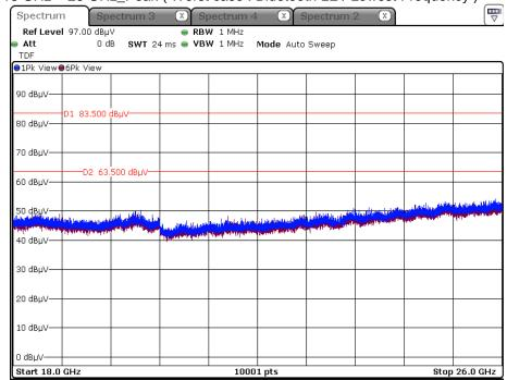
Note 1 : Measured distance : 1 m Note 2 : Limit : Peak : 83.5 dBµV/m Average : 63.5 dBµV/m
