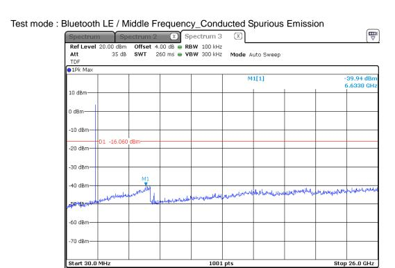
Note 1 : Reference : 3.94 dBm Limit : 3.94 dBm - 20 dB = -16.06 dBm
