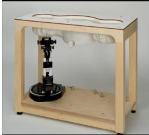
Fig. 15-3 SAM Twin Phantom
