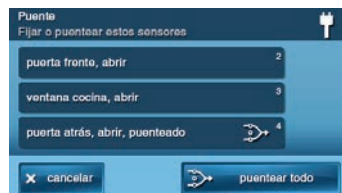
Pantalla de puenteo forzado de sensores
