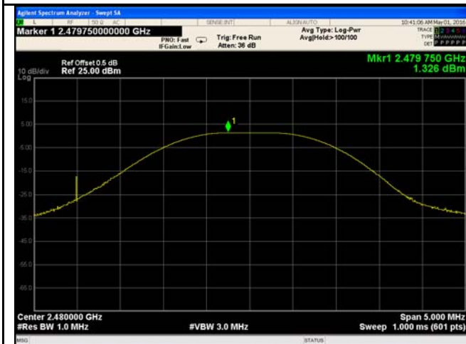
AV Output power - High CH 2480
