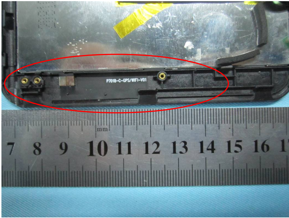
Bluetooth / BLE / WIFI Antenna View
