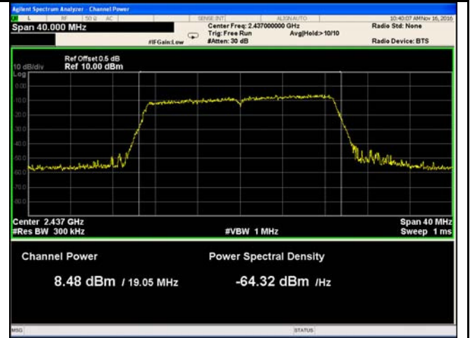
802.11n20 - AV Output power - Mid CH 2437
