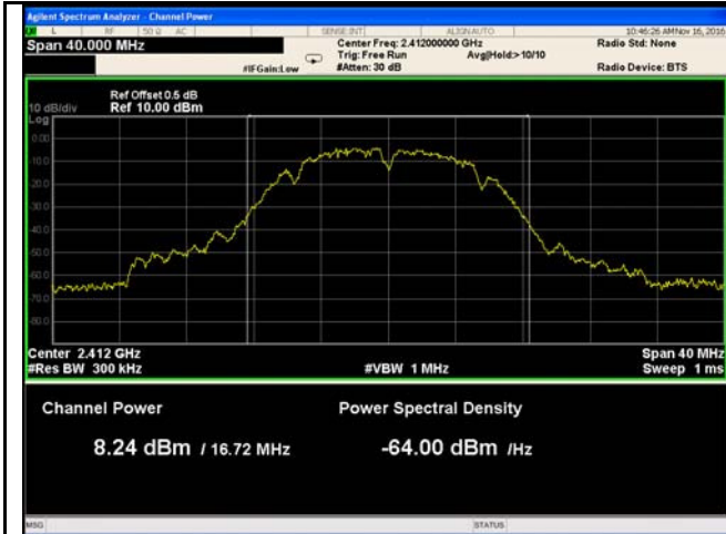
802.11b - AV Output power - Low CH 2412
