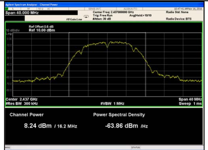
802.11b - AV Output power - Mid CH 2437
