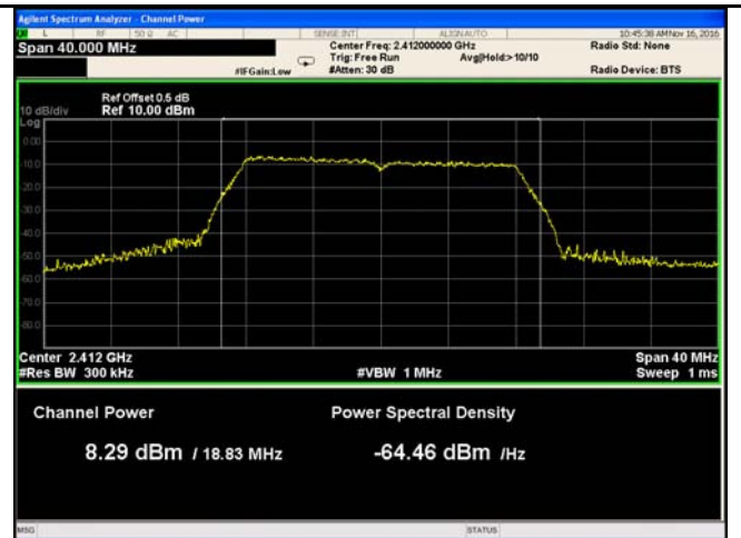
802.11g - AV Output power - Low CH 2412
