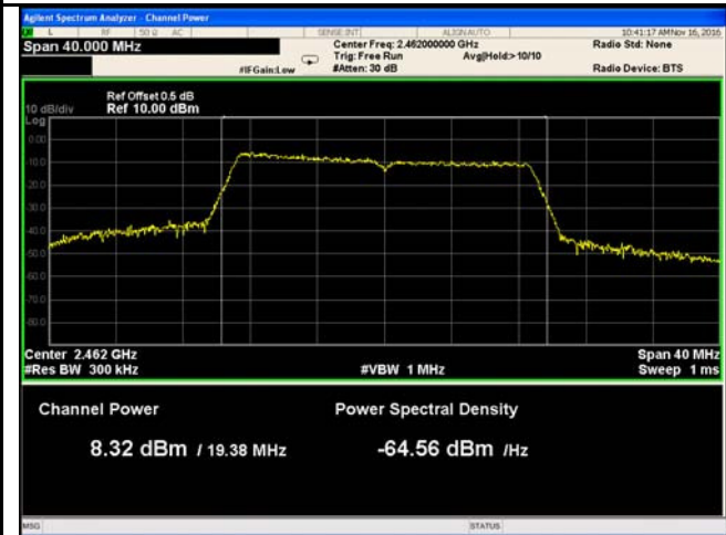
802.11n20 - AV Output power - High CH 2462
