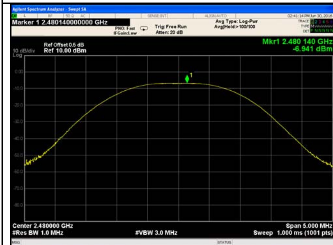
AV Output power - High CH 2480
