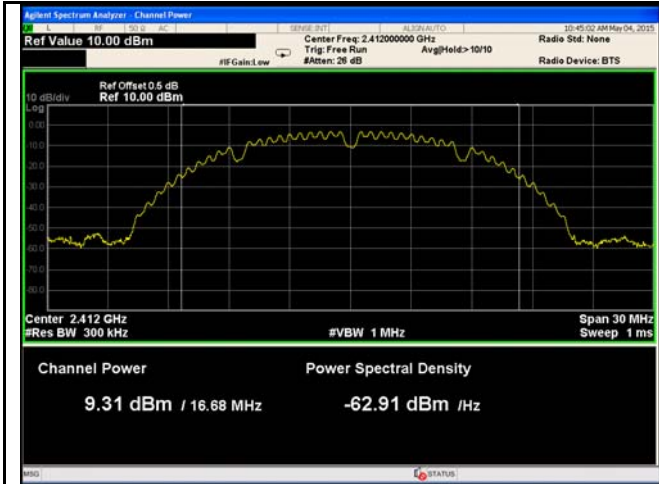
802.11b - AV Output power - Low CH 2412
