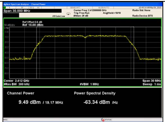
802.11g - AV Output power - Low CH 2412
