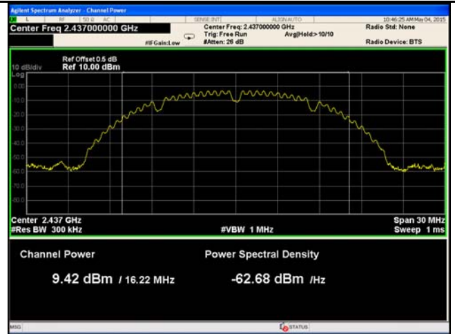
802.11b - AV Output power - Mid CH 2437
