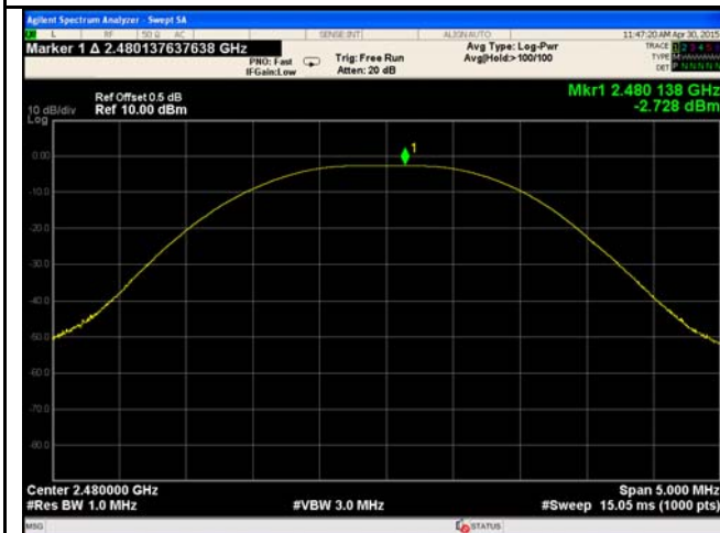
AV Output power - High CH 2480
