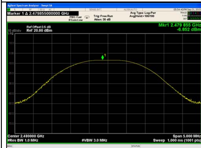
AV Output power - High CH 2480
