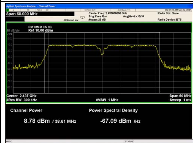
802.11n40 - AV Output power - Mid CH 2437
