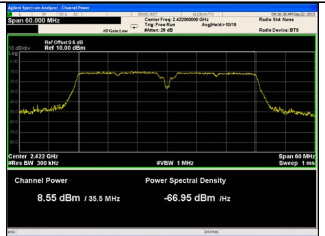
802.11n40 - AV Output power - Low CH 2422
