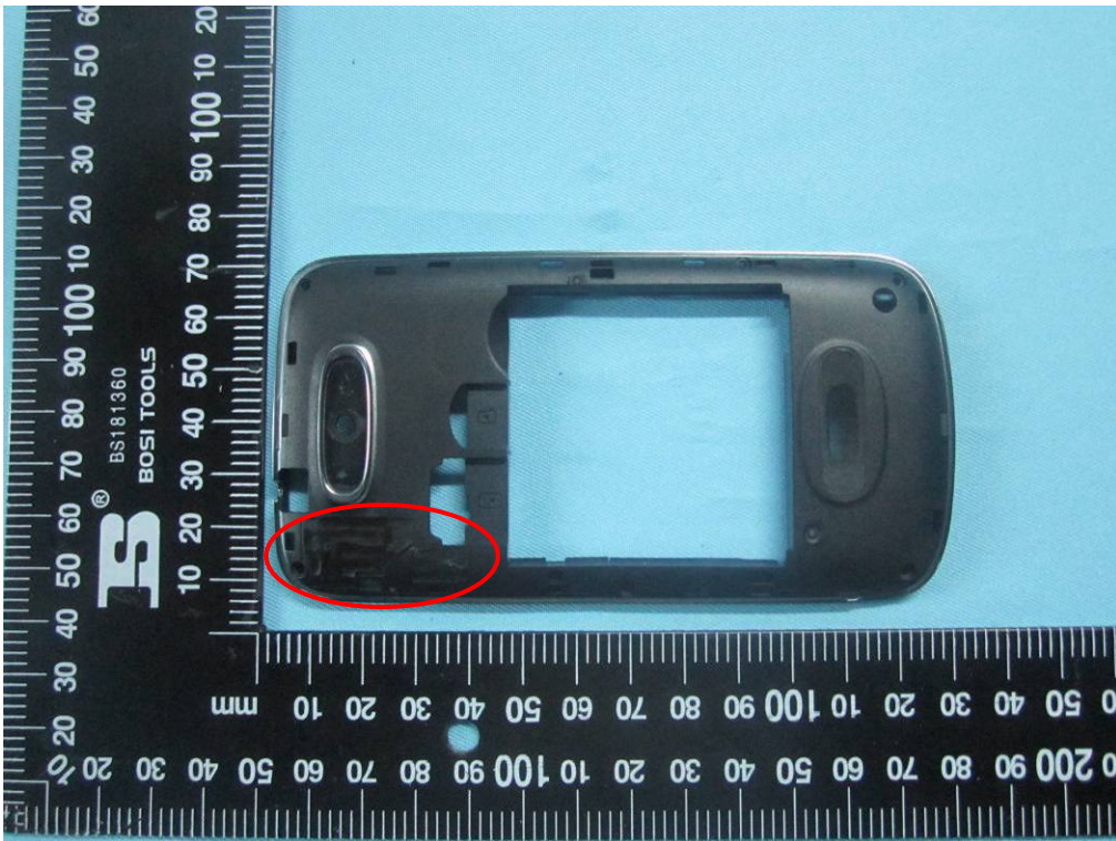
Bluetooth / BLE / WIFI Antenna View
