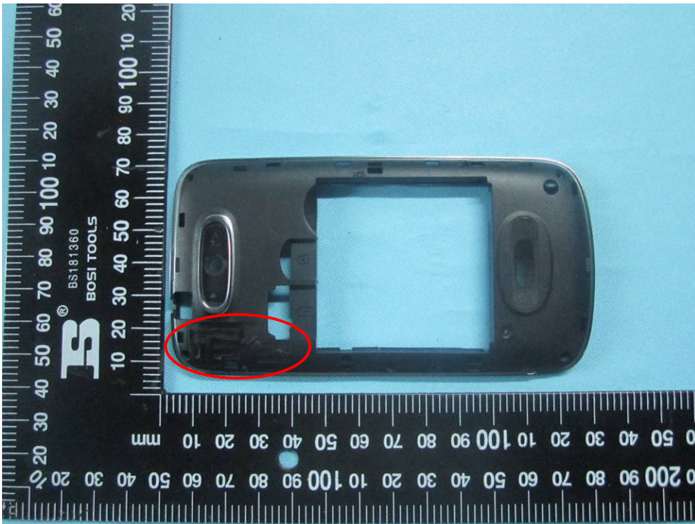
Bluetooth / BLE / WIFI Antenna View
