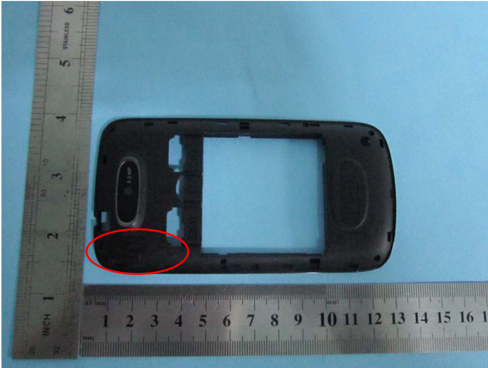
Bluetooth / BLE / WIFI Antenna View
