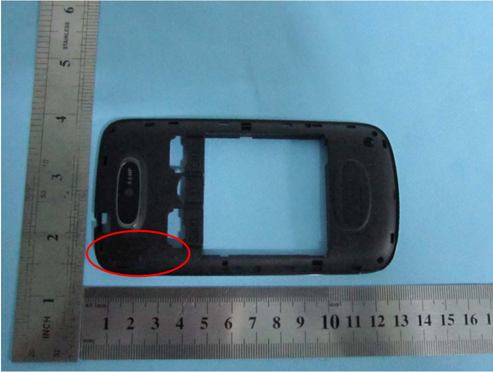
Bluetooth / BLE / WIFI Antenna View
