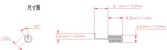
15F0 GBT-915-0,5\*4,5\*8,5\*9,75N-8\*3,6L 弹簧: 线径0,5mm,圈数9,75,材质黄铜
