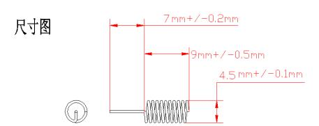
26F0 天线 (直角) GBT-915-0.5\*4.5\*9.2\*10N-4.5\*4\*2.7L-1L(HP3002) 弹簧: 线径0.5mm, 圈数9.75,材质黄铜
