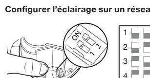
Après avoir inséré les piles, choisissez l'un des 4 canaux pour vos projecteurs avec les commutateurs à proximité du compartiment des piles. Vérifiez que toutes les unités sont sur le même canal en accouplant les commutateurs.
