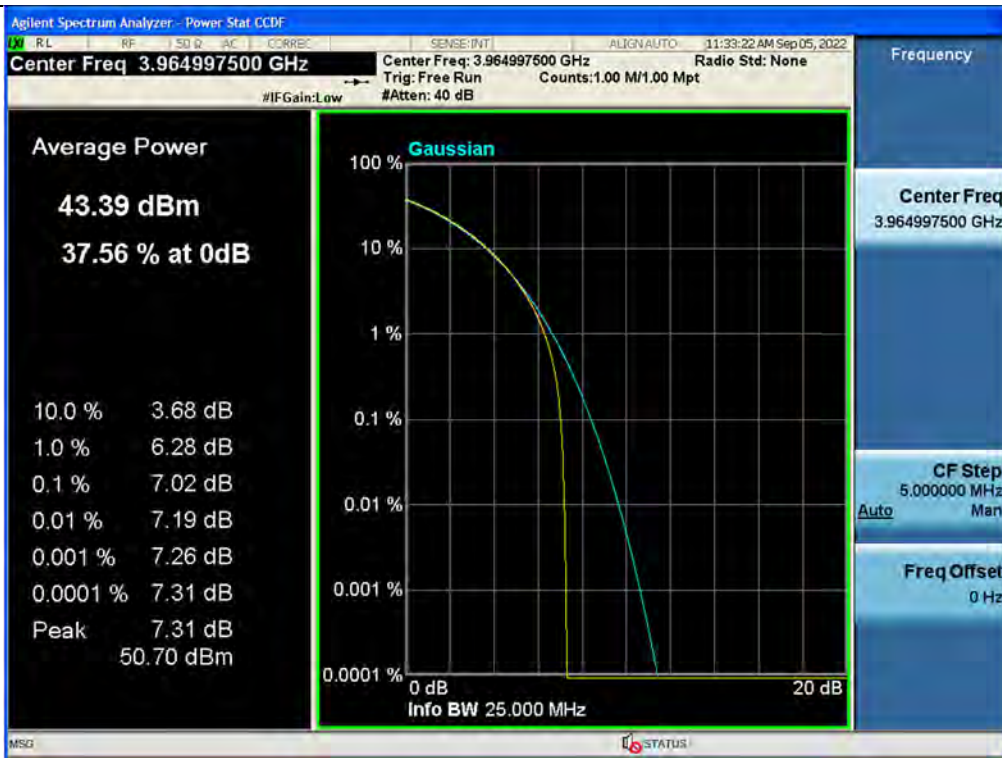
PAPR / C-Band(Ant1) / Downlink / 5G NR 20 MHz
