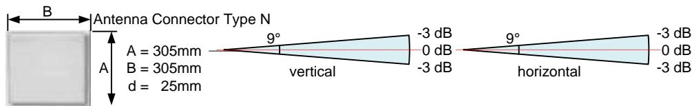
Figure 46: LPR® 1D antenna
