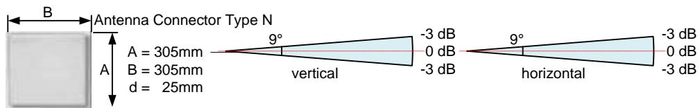
Figure 47: LPR® 1D antenna
