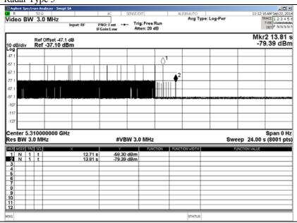
Marker 1 : End of Burst : 12710 ms Marker 2 : End of Transmission : 13810ms
