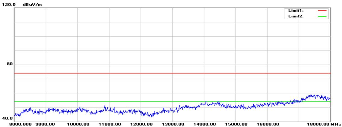
**Operation Mode:** TX / GFSK / DH5 / CH Mid
