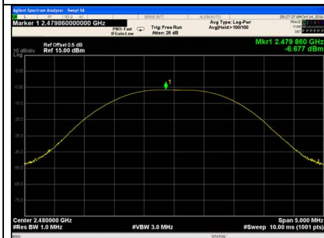
AV Output power - High CH 2480
