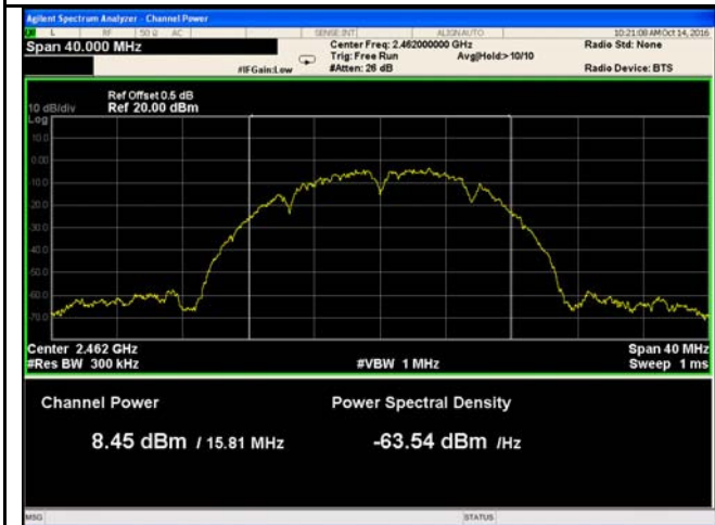
802.11b - AV Output power - High CH 2462
