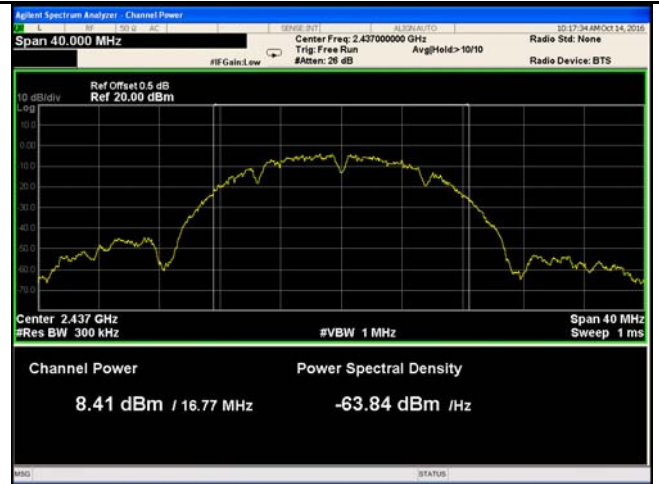
802.11b - AV Output power - Mid CH 2437
