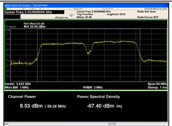
802.11n40 - AV Output power - High CH 2452
