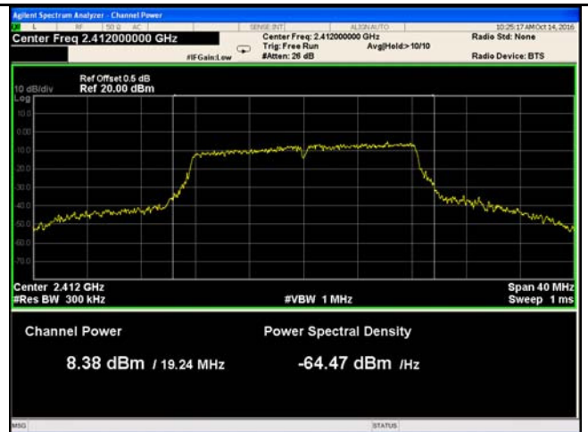
802.11g - AV Output power - Low CH 2412
