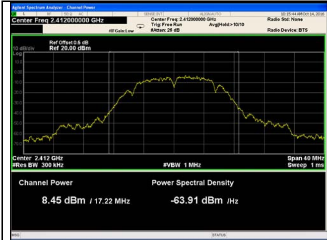
802.11b - AV Output power - Low CH 2412
