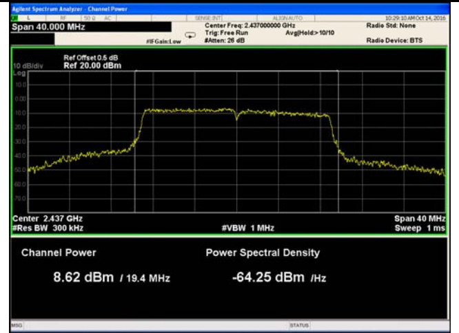
802.11n20 - AV Output power - Mid CH 2437
