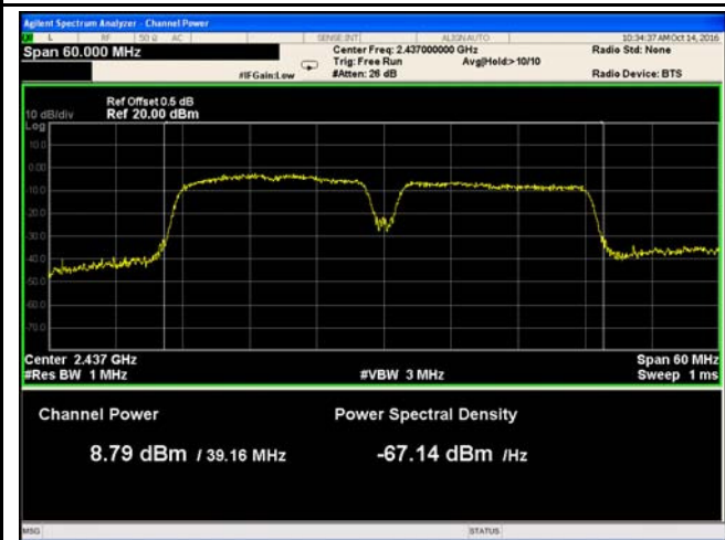
802.11n40 - AV Output power - Mid CH 2437
