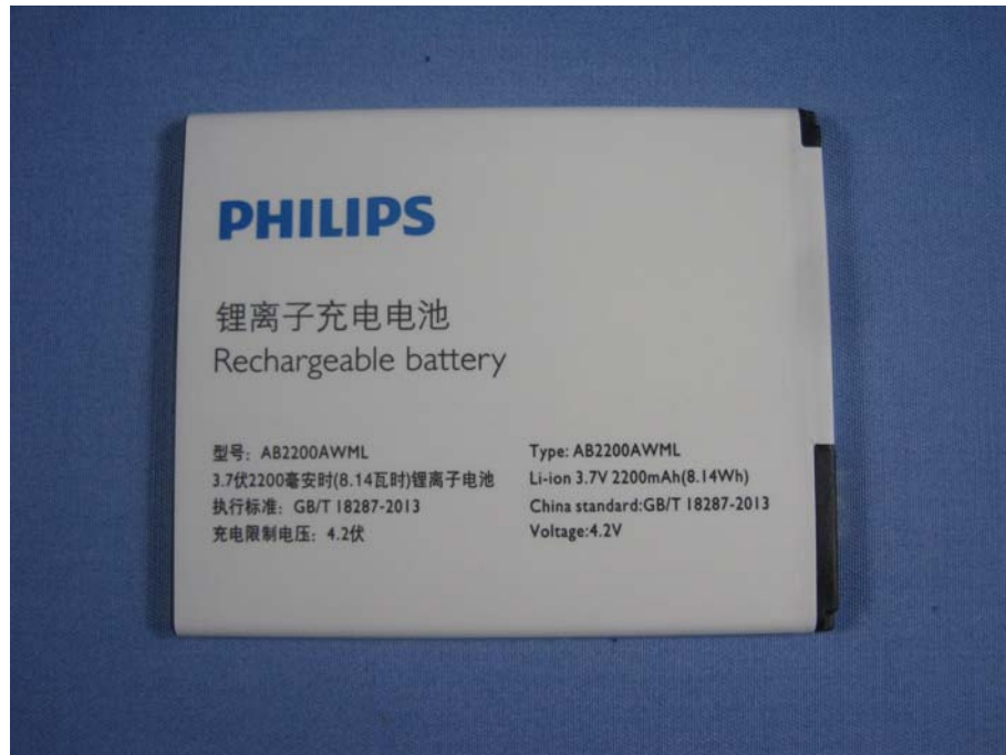
Pic A-3 Battery
