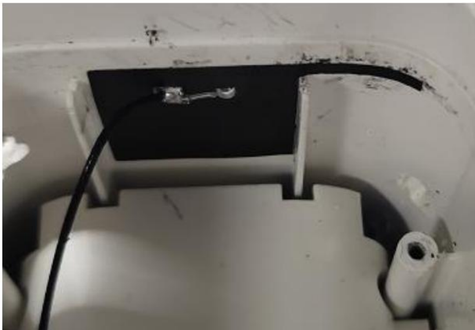
天线安装位置
