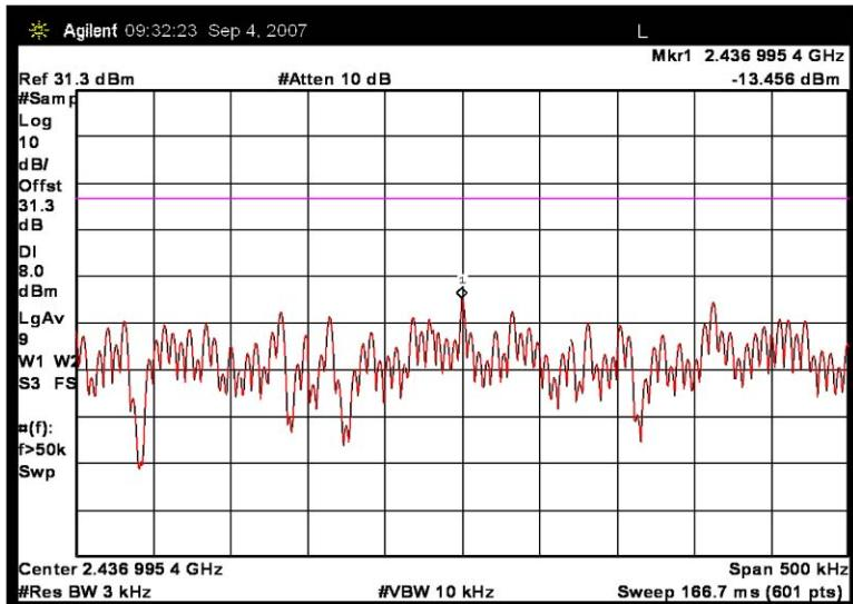
**POWER SPECTRAL DENSITY - 802.11b HIGH - 12.5dBm**
