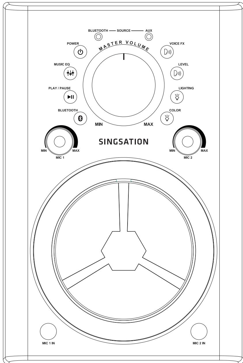
Le **voyant BLUETOOTH** indique l'état Bluetooth de la Singsation Classic (le fixe indique la connexion, le clignotement rapide signifie l'appariement et le clignotement lent signifie la connexion en cours).
