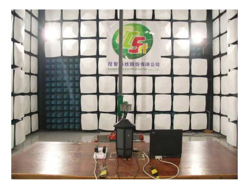
**RADIATED EMISSION TEST**
