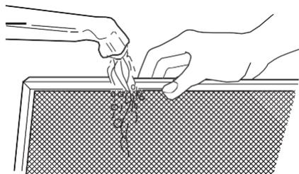
2. Faites tremper le filtre à graisse dans de l'eau chaude en utilisant un détergent doux. Rincez-le bien et secouez-le pour le sécher ou lavez le filtre à graisse au lave-vaisselle. Il est préférable de le placer dans le panier supérieur du lave-vaisselle pour le nettoyer.
