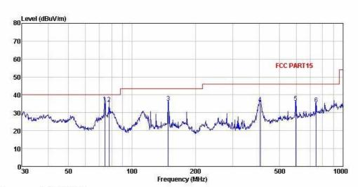
: 3m chamber : FCC PART15 3m VULB9163(NEW) VERTICAL : Chumby Netv : CHU-NTLV
