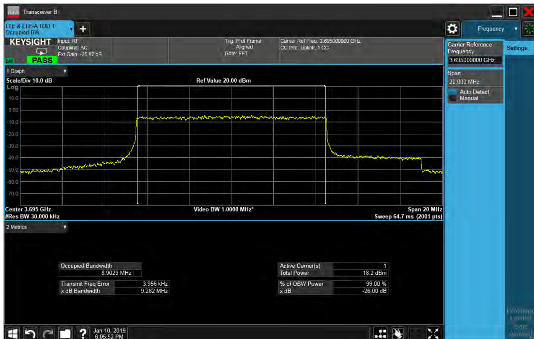
LTE CA intra-band 48 / 15(5+10) / 10MHz(SCC) / 64QAM - RB Size 75(25+50)
