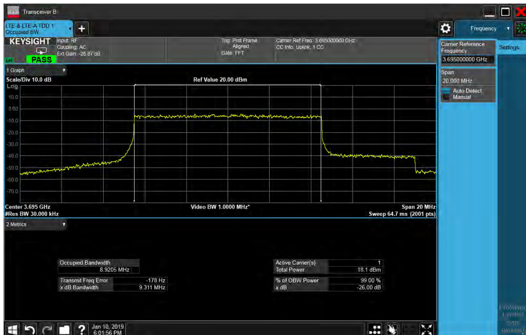
LTE CA intra-band 48 / 15(5+10) / 10MHz(SCC) / QPSK - RB Size 75(25+50)
