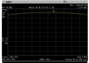
Figure 5-2a: Peak Output Power, EDR DQPSK Channel 39.
