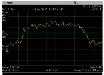
Figure 6-1b: 20dB Bandwidth EDR DQPSK, Channel 0.
