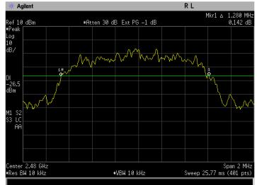
Figure 6-3b: 20dB Bandwidth EDR DQPSK, Channel 78.
