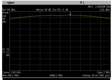
Figure 5-3a: Peak Output Power, EDR DQPSK Channel 78.
