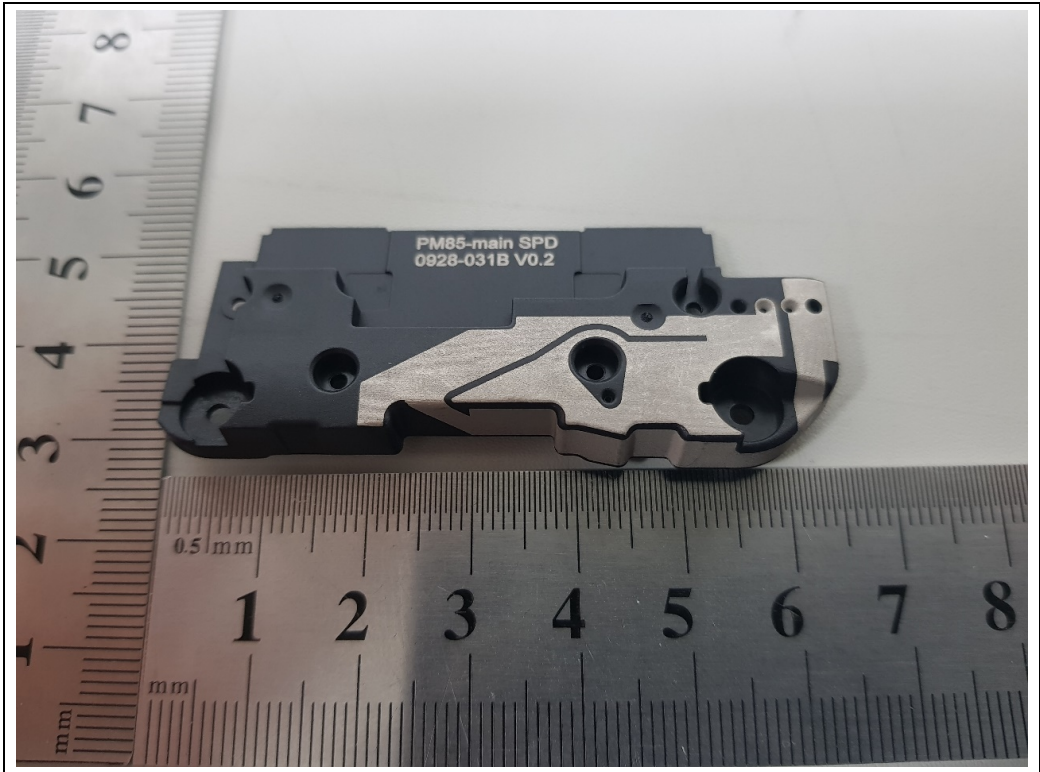
<Main GSM/WCDMA/LTE Antenna>
