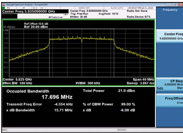
U-NII-3 6dB Bandwidth-802.11ac(20MHz) ,5825MHz,Ant1
