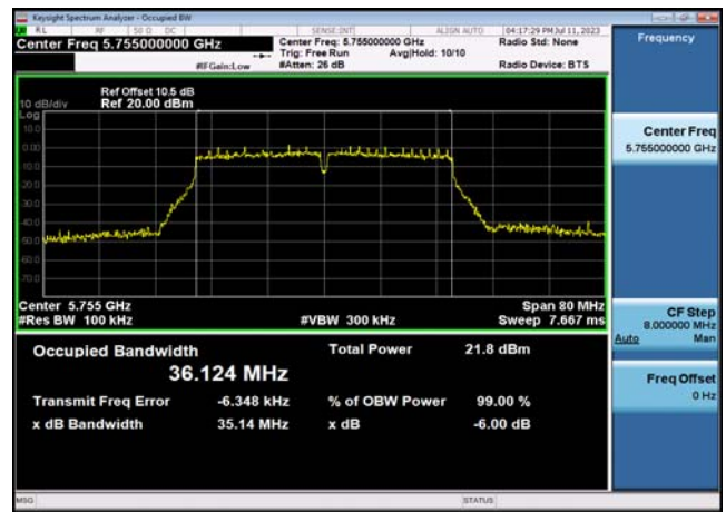
U-NII-3 6dB Bandwidth-802.11ac(40MHz) ,5755MHz,Ant1
