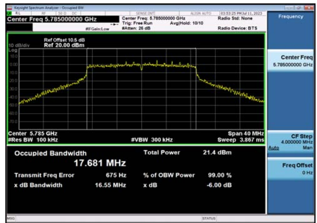
U-NII-3 6dB Bandwidth-802.11ac(40MHz) ,5755MHz,Ant1
