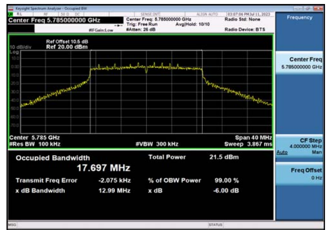
U-NII-3 6dB Bandwidth-802.11n(40MHz) ,5755MHz,Ant1
