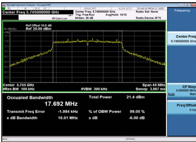
U-NII-3 6dB Bandwidth-802.11ac(20MHz) ,5825MHz,Ant1
