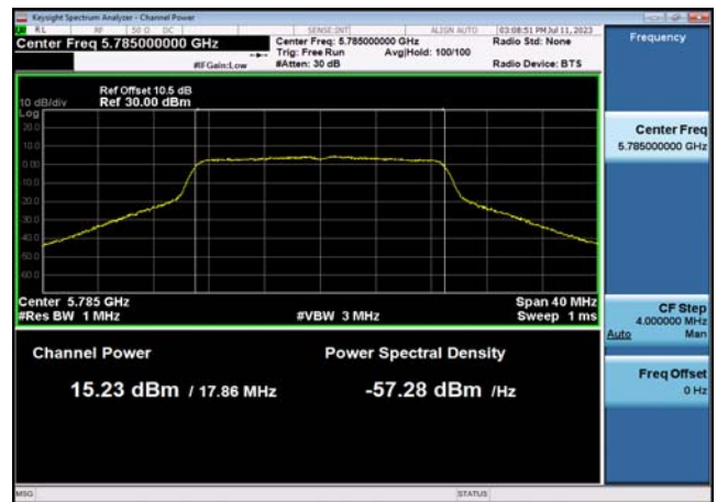
U-NII-3 Output Power-802.11n(40MHz) ,5755MHz,Ant1
