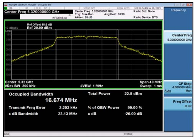
U-NII-2a 26dB&99% Bandwidth-802.11ac(20MHz) ,5300MHz,Ant1
