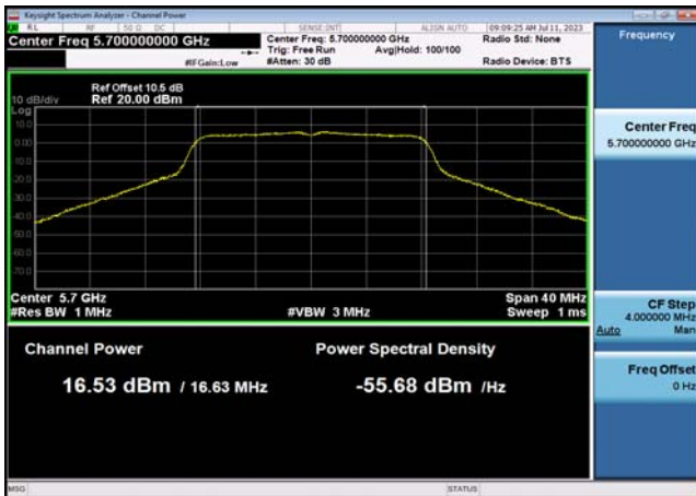
U-NII-2c Output Power-802.11ac(20MHz) ,5580MHz,Ant1
