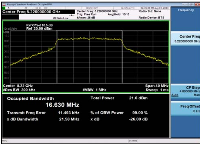
U-NII-1 26dB&99% Bandwidth-802.11ac(20MHz) ,5180MHz,Ant1
