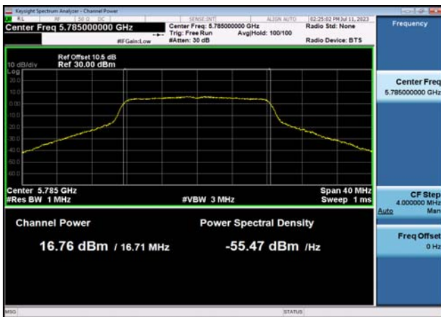
U-NII-3 Output Power-802.11ac(20MHz) ,5745MHz,Ant1
