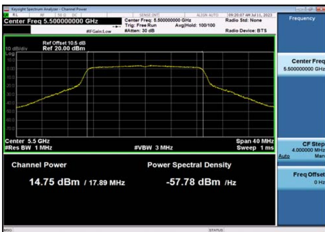
U-NII-2c Output Power-802.11n(20MHz) ,5500MHz,Ant1
