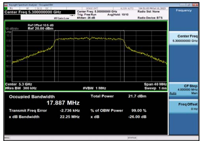
U-NII-2a 26dB&99% Bandwidth-802.11ac(20MHz) ,5300MHz,Ant1
