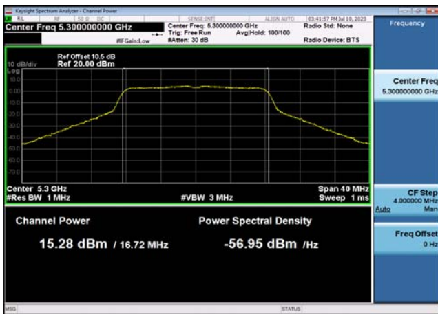
U-NII-2a Output Power-802.11ac(20MHz) ,5260MHz,Ant1
