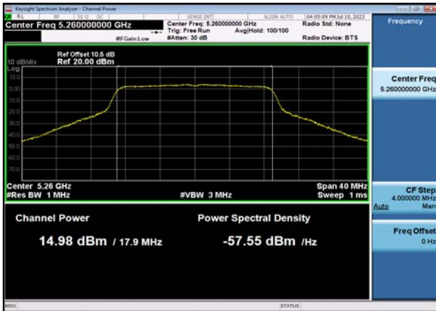
U-NII-2a Output Power-802.11n(20MHz) ,5320MHz,Ant1
