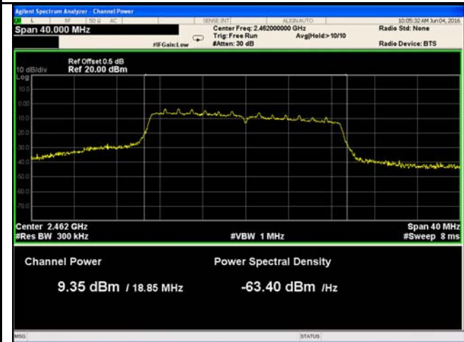
802.11n20 - AV Output power - High CH 2462
