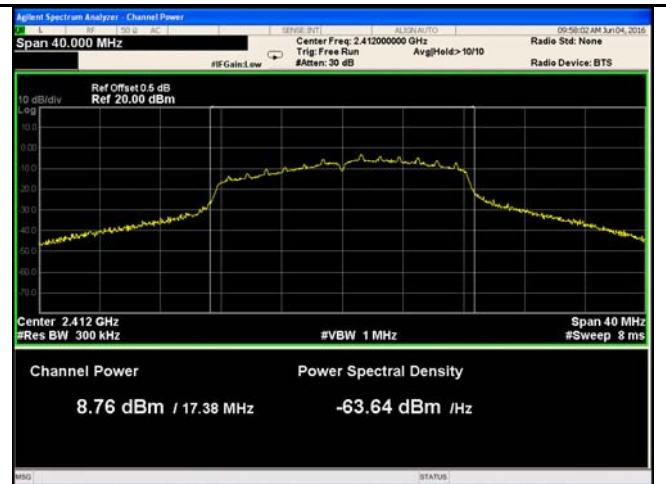
802.11g - AV Output power - Low CH 2412
