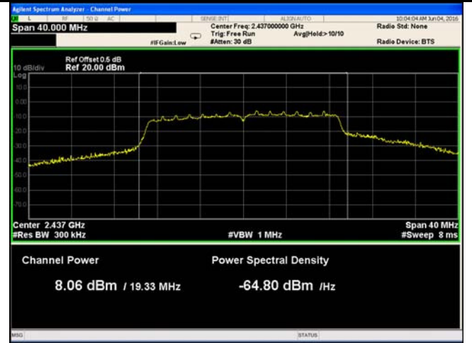
802.11n20 - AV Output power - Mid CH 2437
