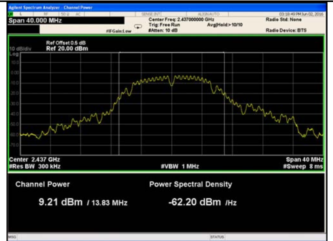
802.11b - AV Output power - Mid CH 2437
