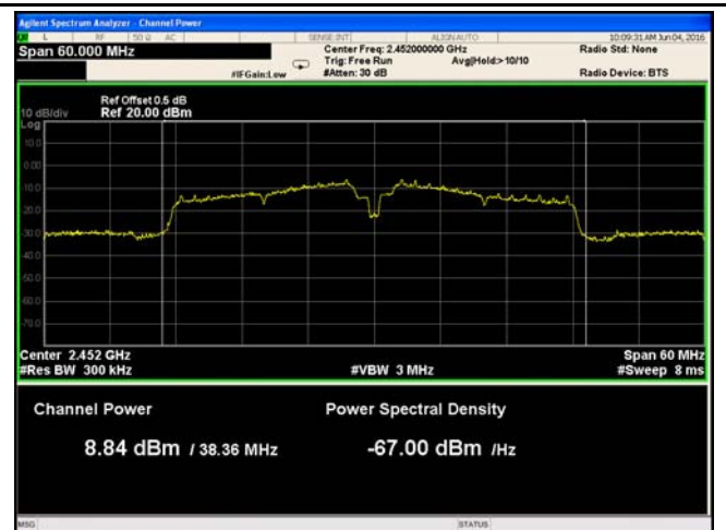
802.11n40 - AV Output power - High CH 2452
