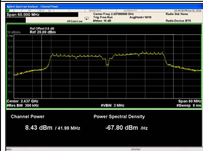
802.11n40 - AV Output power - Mid CH 2437
