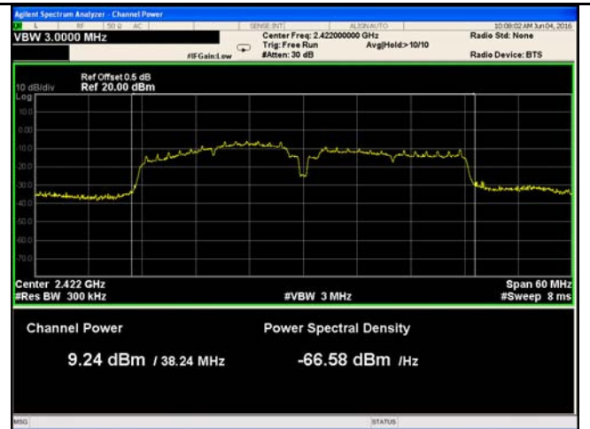
802.11n40 - AV Output power - Low CH 2422
