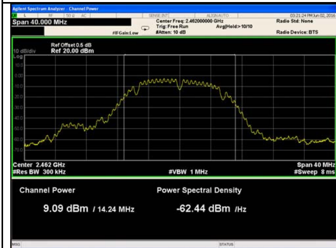
802.11b - AV Output power - High CH 2462
