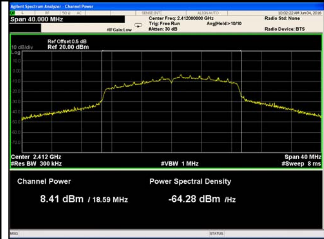
802.11n20 - AV Output power - Low CH 2412
