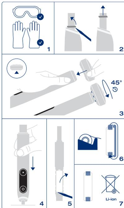
**Ouvrir le compartiment à pile situé dans le manche comme indiqué, retirer la pile et la jeter conformément aux règlements locaux. Attention! L'ouverture du manche rend l'appareil inutilisable et invalide la garantie.**
