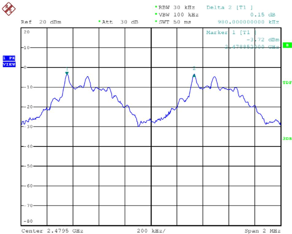
Modulation Standard:  $\pi/4$ -DQPSK (2Mbps)
