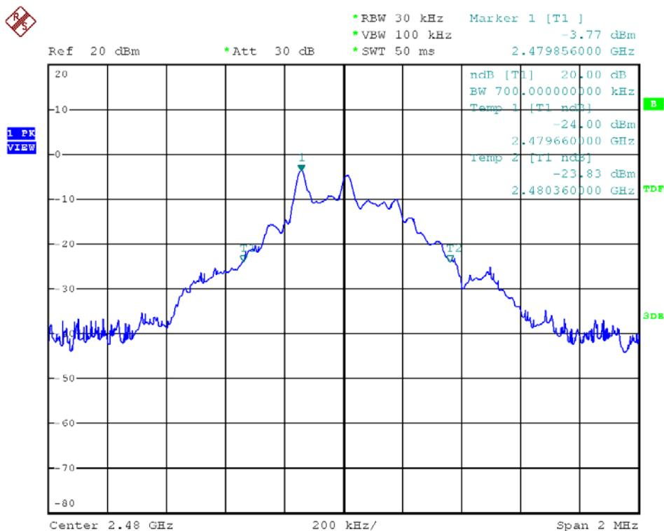
Modulation Standard:  $\pi/4$ -DQPSK (2Mbps)
