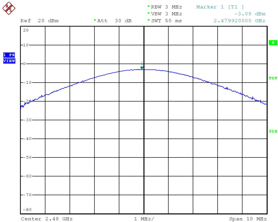
Modulation Standard:  $\pi/4$ -DQPSK (2Mbps)
