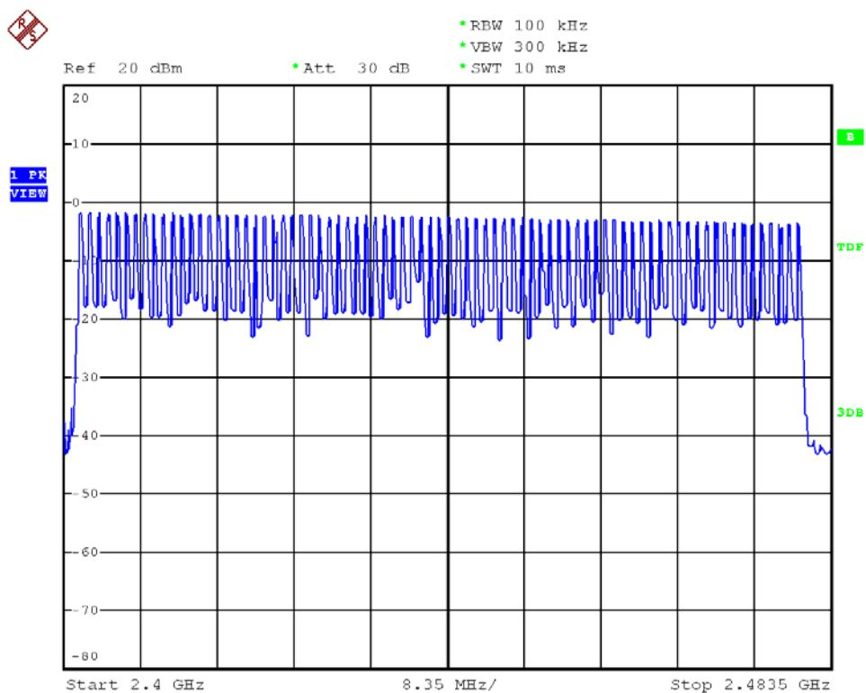
Modulation Standard:  $\pi/4$ -DQPSK (2Mbps)
