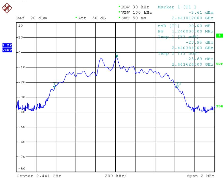
Modulation Standard:  $\pi/4$ -DQPSK (2Mbps)
