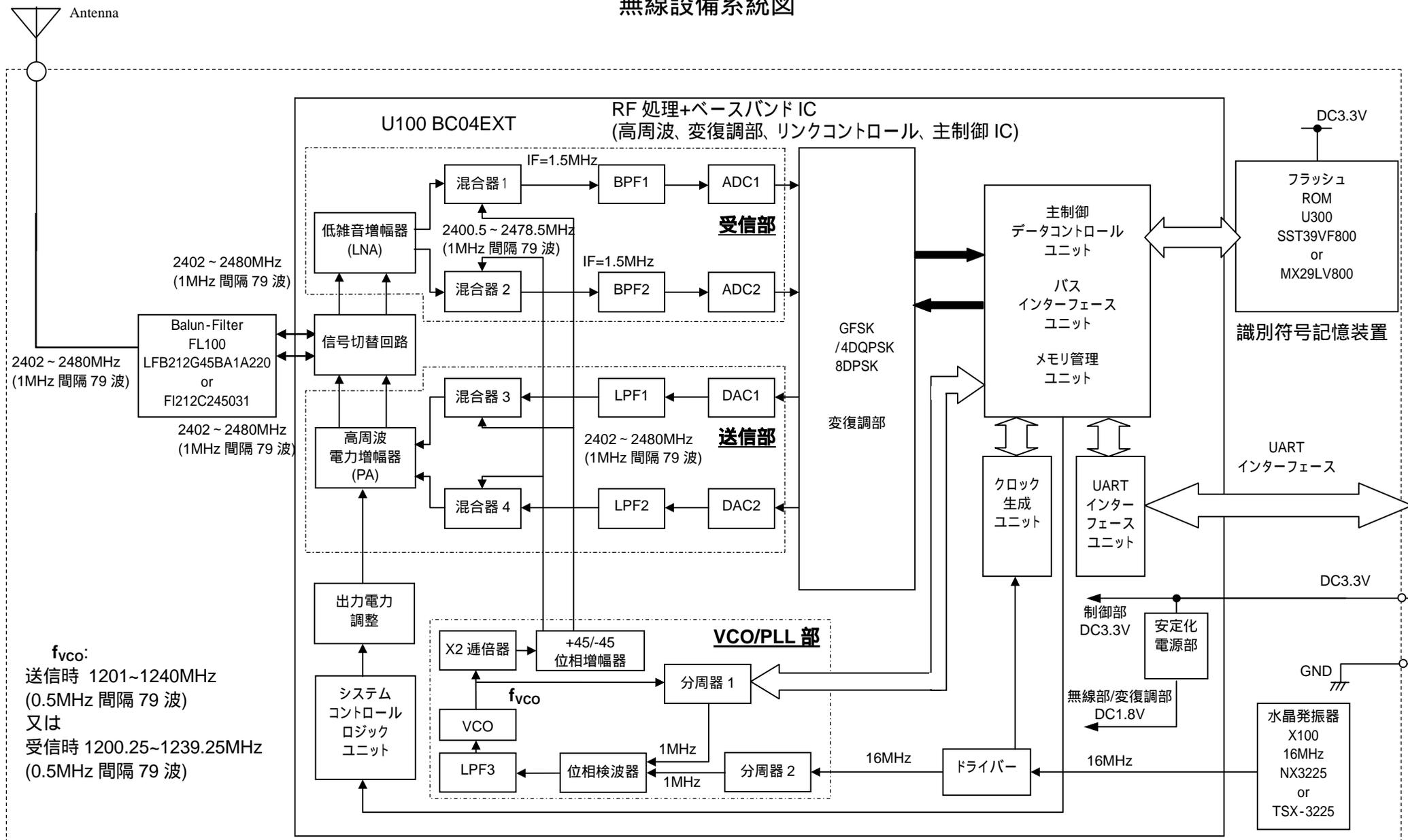
破線内がシールドケースに収容された回路
