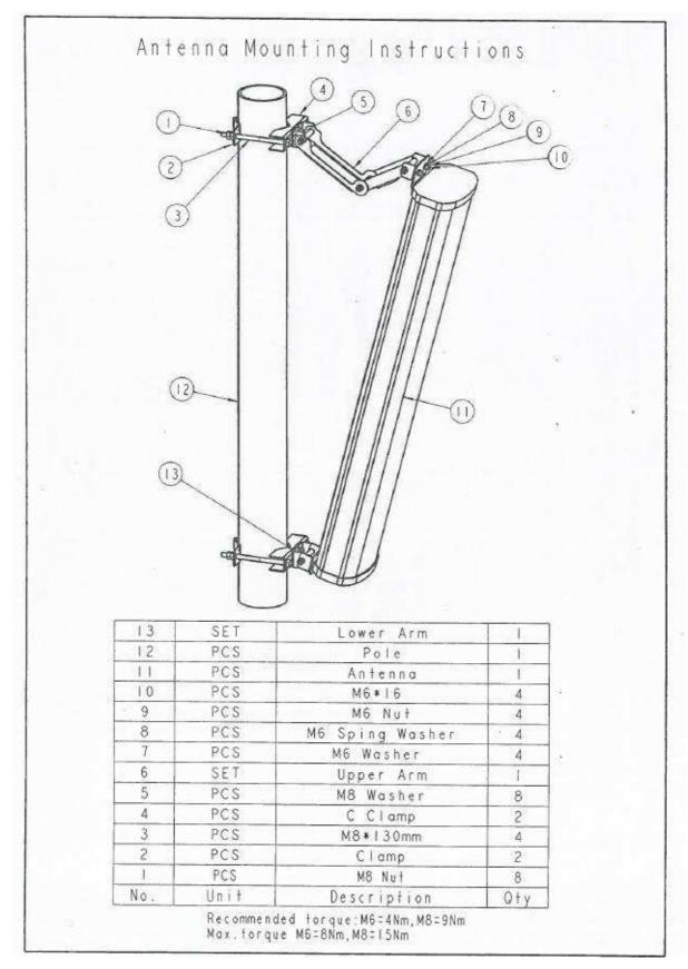
Mechanical Downtilt: 0° – 30° Pole Diameter: 30 mm – 80 mm
