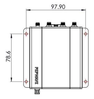
ON MOUNTING PLATE, - DRILL  $\emptyset$  3.3 FOR M3 SCREW - DRILL  $\emptyset$  3.8 FOR M3.5 SCREW
