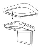
La moldura de ajuste se usa para lograr que la pantalla quede al ras del contorno del techo. Solicite más detalles al distribuidor de ALPINE.
