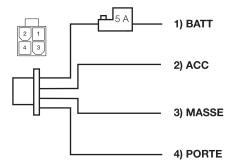
L'appareil PKG-RSE3HDMI d'ALPINE nécessite les raccordements suivants à l'alimentation pour garantir le bon fonctionnement du
