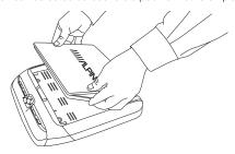
Fermez le couvercle du moniteur et appuyez sur la partie arrière du couvercle pour le mettre en place.
