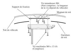
Installez l'anneau de garniture avant de fixer le moniteur suspendu au support d'installation en métal.
