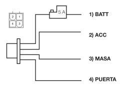
Se deben realizar las siguientes conexiones de alimentación en la unidad PKG-RSE3HDMI ALPINE para garantizar el correcto funcionamiento de la pantalla.
