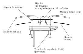
Monte la moldura de ajuste antes de fijar el DVD con pantalla para toldo al soporte metálico de montaje.
