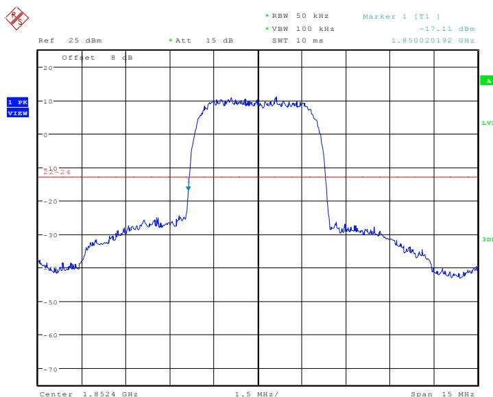
**HIGH BAND EDGE BLOCK-C (WCDMA Band II) –Channel 9538-QPSK**
