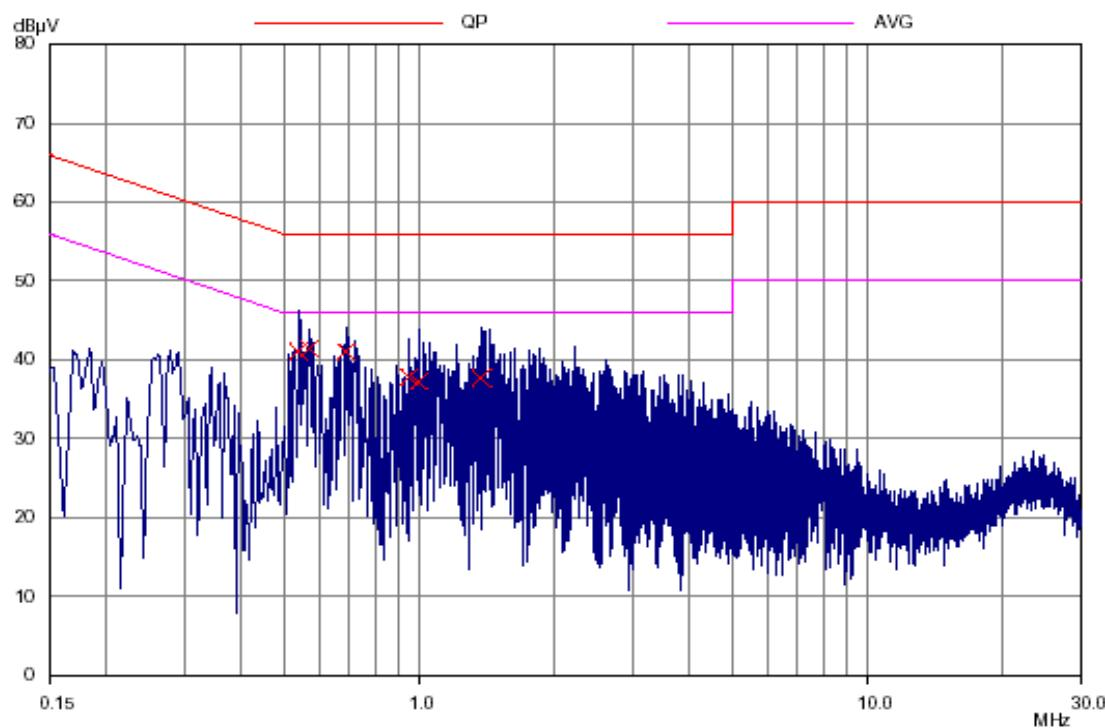
**Model No.: A495 / Adaptor 1**Operation Mode : Base On LineNeutralTest Date : Nov. 22, 2009Temperature : 20 °CHumidity : 72 %
