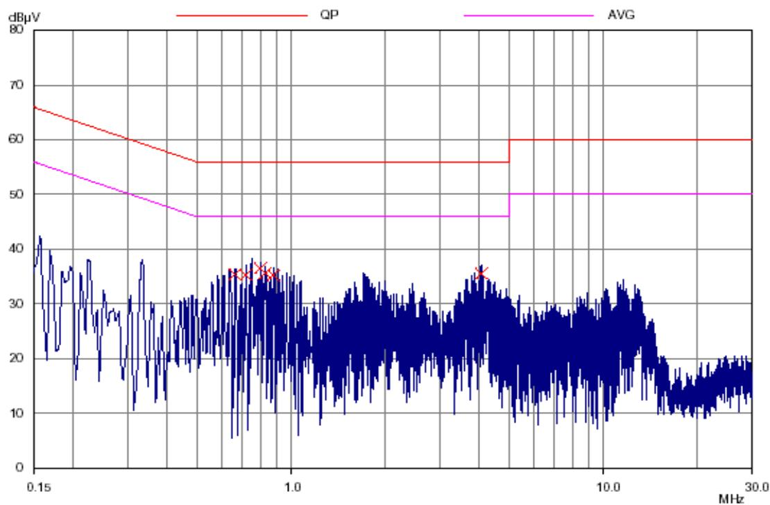
**Model No.: A495 / Adaptor 2**Operation Mode : Base On LineNeutralTest Date : Nov. 22, 2009Temperature : 20 °CHumidity : 72 %
