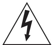
Il simbolo del fulmine con la punta a freccia inserito in un triangolo equilatero segnala all'utente che sono presenti componenti con "tensione ad elevato voltaggio" non isolati all'interno dell'involucro del prodotto, di intensità tale da costituire un rischio per le persone in caso di emissione di scariche elettriche.
