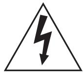
L'éclair avec le symbole de flèche dans un triangle équilatéral sert à alerter l'utilisateur de la présence d'une "tension dangereuse" dans l'enceinte du produit qui peut être d'une ampleur suffisante pour constituer un risque d'électrocution aux personnes.
