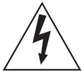
Symbolet med et lyn i en trekant har til formål at gøre brugeren opmærksom på uisoleret "farlig spænding" inden i produktets kabinet, der kan udgøre risiko for elektrisk stød for personer.
