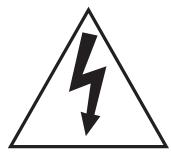
Das Blitzsymbol in einem gleichseitigen Dreieck soll den Benutzer vor dem Vorhandensein von nicht isolierter gefährlicher Spannung in dem Gerätegehäuse warnen, die so stark sein kann, dass sich für Personen die Gefahr eines elektrischen Schlags ergibt.
