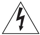
El símbolo del rayo con la punta de flecha dentro de un triángulo equilátero pretende advertir al usuario de la presencia de «tensiones peligrosas» dentro de la carcasa del producto que pueden ser de magnitud suficiente como para constituir un riesgo de descarga eléctrica para las personas.
