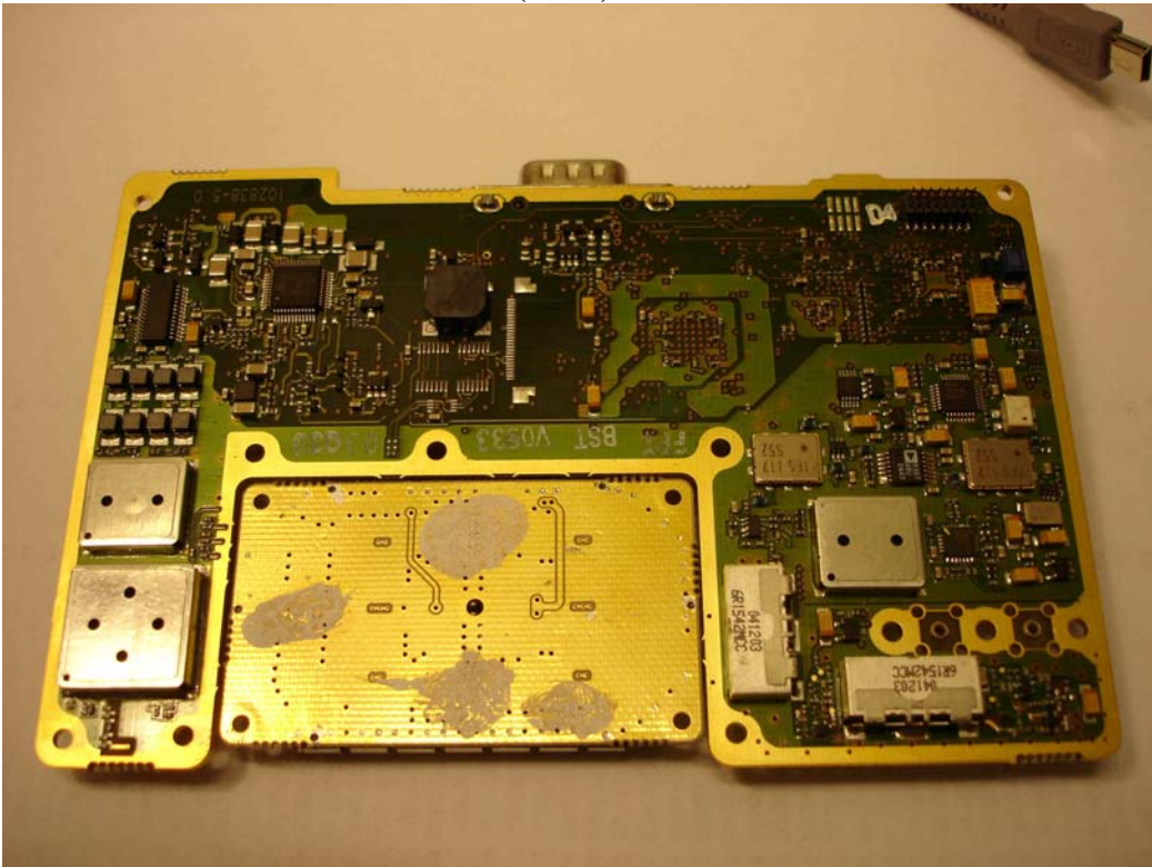
Nera WorldPro 1000 Antenna unit (ODU)
