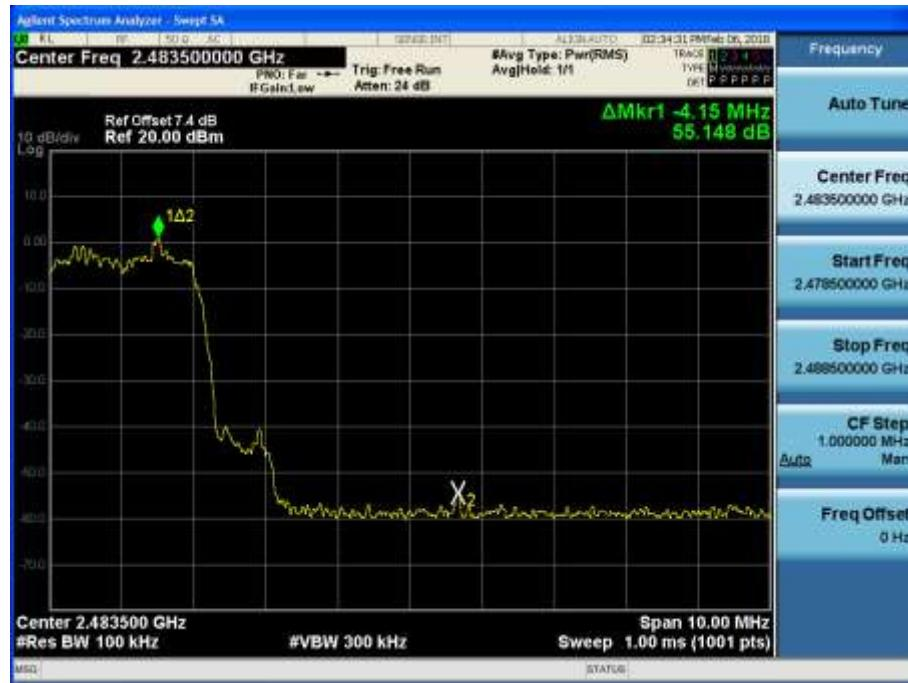
Test Plots with hopping ( $\pi/4$ DQPSK)
