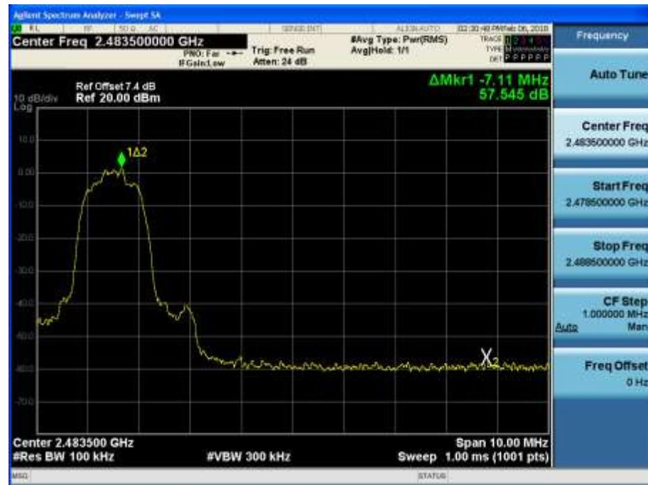
Test Plots without hopping ( $\pi/4$ DQPSK)
