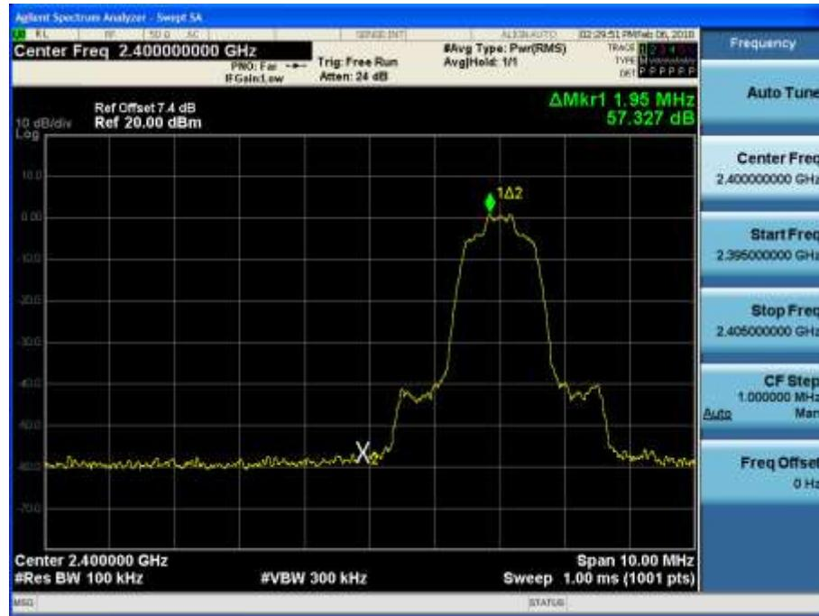
Test Plots without hopping ( $\pi/4$ DQPSK)
