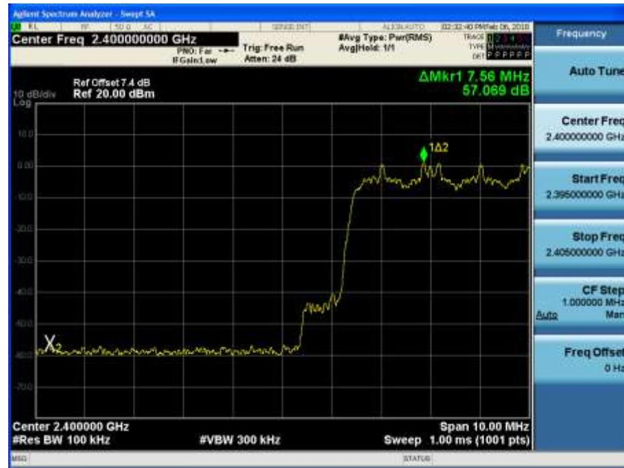
Test Plots with hopping ( $\pi/4$ DQPSK)
